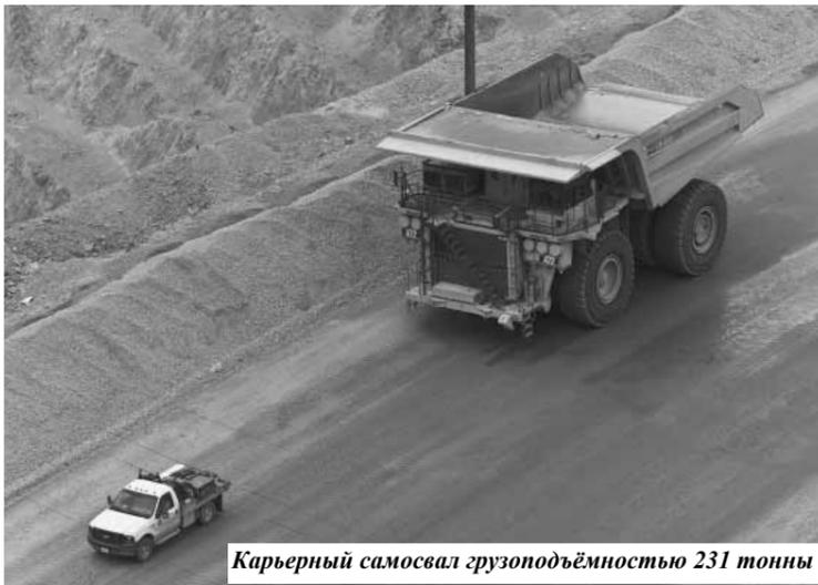
Карьерный самосвал грузоподъемностью 231 тонны
