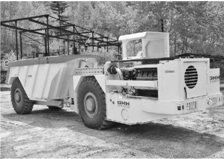
Подземный самосвал «МК-А20» на руднике «Николаевский»
