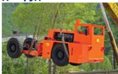
Новый подземный автобус YR-6 произведён в китайском городе Яньтай. Он рассчитан на эксплуатацию в узких подземных выработках и способен перевезти одновременно шесть пассажиров.
